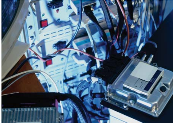
Le calculateur est relié à un système simulant le moteur, le «hardware in the loop».
