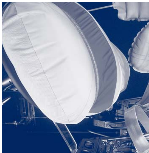
Optima permet aux fournisseurs de mieux s'intégrer dès le stade de la recherche. Ainsi, Autoliv, le spécialiste de la sécurité passive, étudie avec Renault des systèmes inédits de protection des occupants (ci-dessus, un airbag adaptatif déployé).
