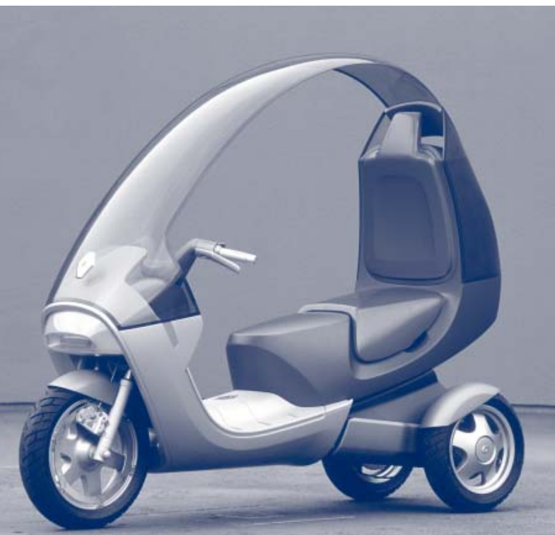
Ublo est un concept expérimental de véhicule à trois roues, intermédiaire entre le deux-roues et une automobile, et susceptible d'être équipé d'une motorisation hybride.
